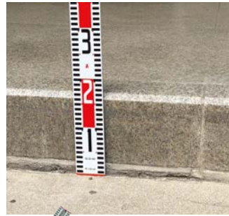
■標尺は、クロス金具を使えば縦・横同時に測れます。
